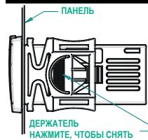
Контроллер XR20CX должен монтироваться на вертикальной панели в вырез 29x71мм и закрепляться, используя поставляемые специальные держатели. Диапазон температур, разрешенный для правильной эксплуатации - 0÷60°C. Избегайте мест, подверженных сильной вибрации, с присутствием агрессивных газов, чрезмерной запыленностью или влажностью. Те же рекомендации применимые и к датчикам. Позвольте воздуху циркулировать через отверстия для охлаждения..
