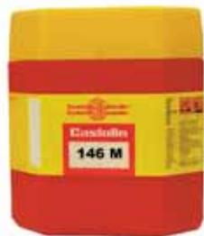
Флюс 146 M - флюс для пайки латуни/бронзы. Нетоксичный, некоррозионный не содержит борную кислоту, буру, хлориды и фториды. Остатки флюса можно не удалять после пайки, они не оказывают побочных действий, как остатки флюсов, содержащих борную кислоту или буру. 146 M оказывает такое же действие, как бура или флюсы, содержащие борную кислоту, но является при этом нетоксичным и невредным.
